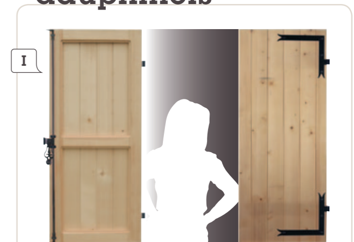
CADRE DE 32 MM ASSEMBLÉ PAR TENON ET MORTAISE FRISES VERTICALES DE 27 MM EN APPLIQUE
