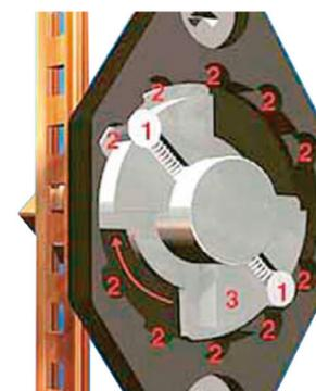
En poursuivant le mouvement de rotation, les goupilles de sécurité (1) sont entraînées par l'élément coupleur (3) vers d'autres évidements (2) dans lesquels elles s'engagent à nouveau en émettant **un cliquetis parfaitement audible.**
